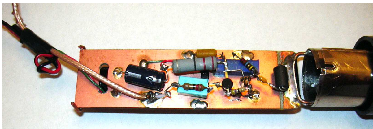
Figura 5: E-antenna: lato componenti. Si nota l'interruzione del rame sotto l'impedenza VK200
