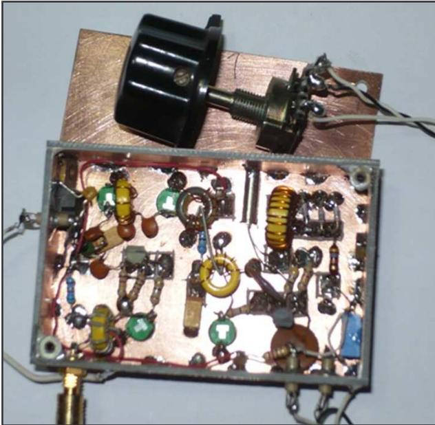
potenziometro Clarity alla MAIN UNIT. Il potenziometro va ai 3 ingressi del VXO mentre tra E e CRL e CLR e CLR8 vanno saldate 2 resistenze da 4.7 kohm. Per l'impostazione dei canali può essere
