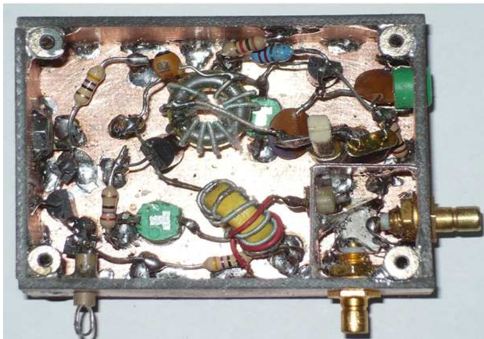
Generatore LO e 2° mixer 455 Kc visto da sopra A dx in basso lo scomparto schermato con il mixer SMD RMS-1H I 2 connett. IN/OUT sono in prossimità dei rispettivi terminali Il segnale LO di + 17 dBm entra attraverso il passante isolato In alto a dx il compensat. Cv1 per la regolazione fine frequenza
