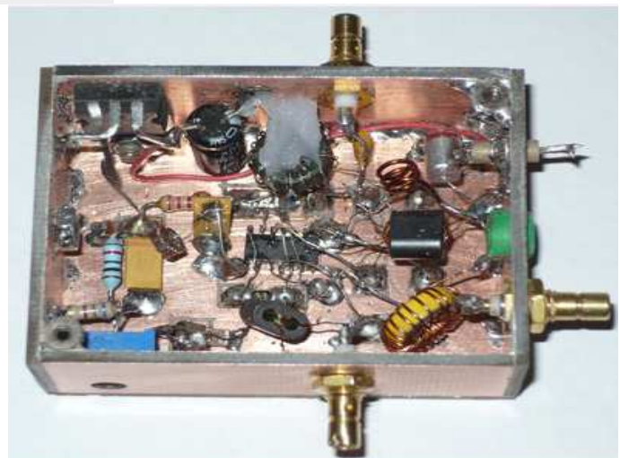
Vista dall'alto del 1° mixer+diplexer Le piazzole di ancoraggio sono fresate sul fondo In centro il FST3125(smd). I terminali sono collegati alle piazzole con filo da 0.25 mm In basso a sx il trimmer azzurro P1. In alto centro il trasf. di ingresso T2, in basso centro T1. A dx centro T3 con sopra L1 e sotto L2. con il verde Cv1. I cond. di by-pass CF sono SMD e saldati tra le piazzole e la massa
