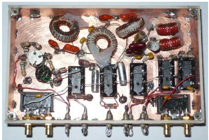
Vista dall'alto del modulo FRONT-END senza coperchio In basso a sx-dx i 2 microrelè comm. rx/tx (max 50 W) I nuclei sono fissati al fondo con silicone da vetri. Gli ancoraggi sono ottenuti fresando la vetronite con "Dremel". Il preampli è a sx, Tr1 è incollato alla base interponendo uno spessore di mica I due microrelè - attenuatori sono a dx. per ottenere i valori esatti le resistenze sono state "molate" partendo da un valore più basso
