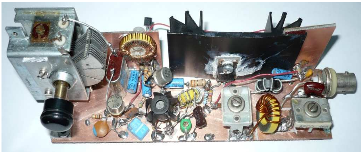
La mia realizzazione, come sempre realizzata su un pezzo di vetronite
