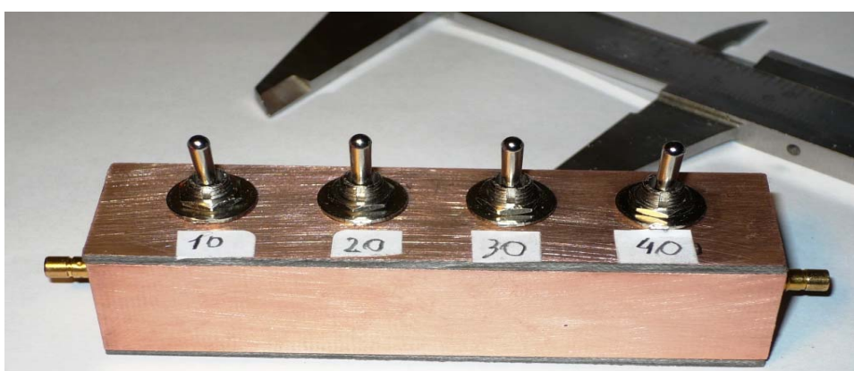
La realizzazione ultimata; ai lati i connettori SMB
