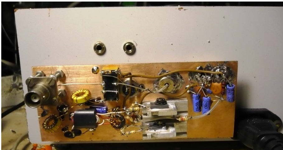
Vista del modulo posteriore da 4 Watt senza copertura. Riceve l'alimentazione +/- 13.5V dallo stesso RTX. I due finali in controfase sono BD139. Le due prese, montate sul pannello posteriore del ricetrasmittitore, sono utilizzate per l'altoparlante esterno e per la connessione al computer.
