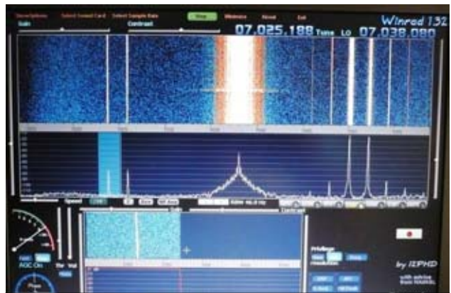
Prova di intermodulazione: ingresso di due portanti distanti 2.5 KHz di -26 dBm. Sullo schermo -10 dBm con imd3 sotto di 80 dB IIP3 = +14 dBm., notare le immagini sotto di oltre 60 dB. Evidente il rumore presente su LO centrale dovuto all'alimentazione switching
