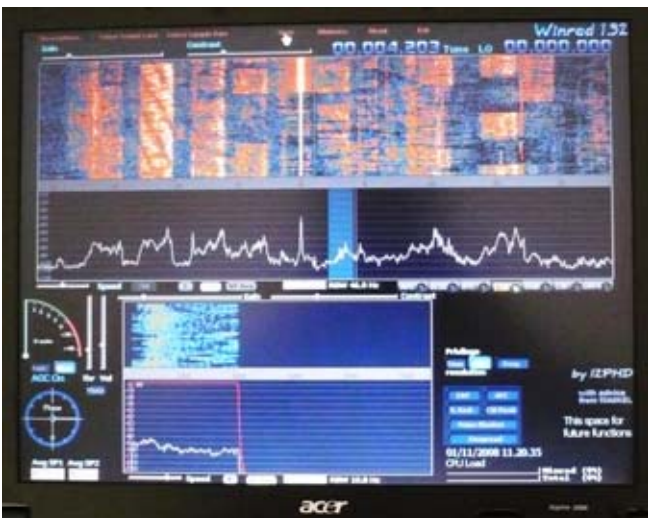
Segnali LSB presenti in 40 tra 7052 e 7099 Kc. Notare il segnale LO centrale molto stretto in quanto utilizzata l'alimentazione a batteria
