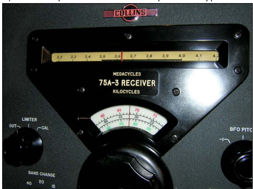
Fig.5 - La scala di lettura della frequenza del 75A-3. L'albero di comando del PTO e' connesso , con un giunto omocinetico , al disco di lettura dei KHz. La lettura dei MHz - indicati su un tamburo rotante mosso dal commutatore di banda - e' ottenuta con un cursore trascinato a mezzo di funicella dall'albero di comando del PTO.
