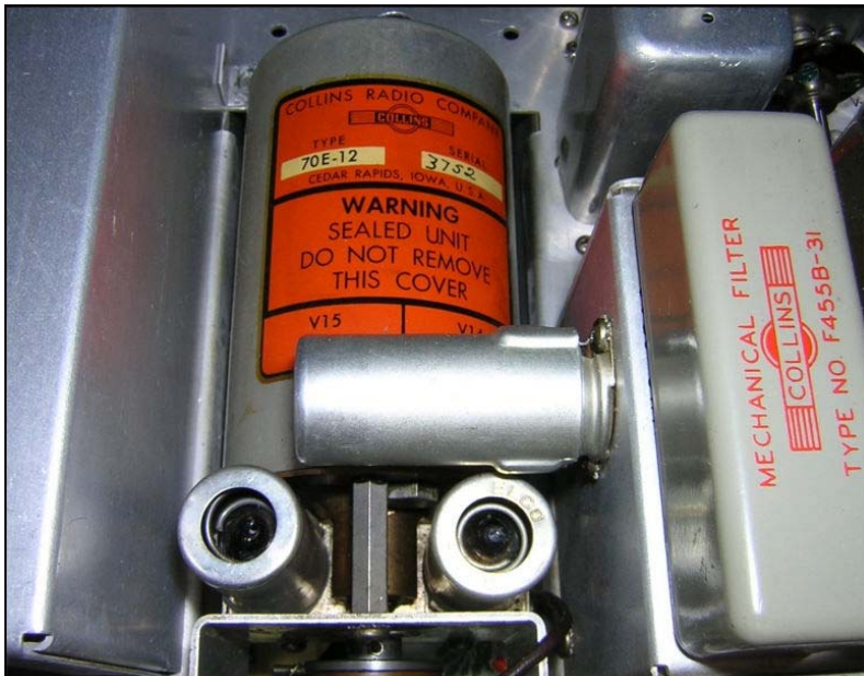
Fig.4 - Il PTO tipo 70E-12 utilizzato nel ricevitore 75A-3. L'esemplare illustrato (serie No 3752) e' stato costruito nel 1953.
