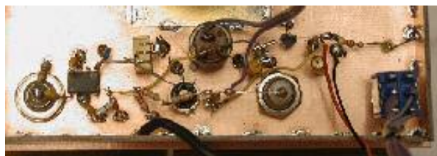
FOTO 5: particolare ingrandito del montaggio componenti; a sinistra , vicino al BNC l'AD8307
